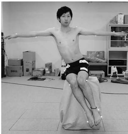
図1 反射マーカ貼付位置と側方移動動作場面 足底が床接地しない高さの台を床反力計の上に設置した。動作は端座位で両上肢を常に床面と平行になるよう外転位を保持したまま最大限側方移動させた。両膝および両側部は閉足位とした。
